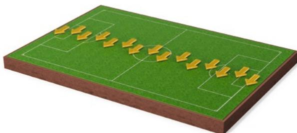
Pfliegerichtung bei gleichlaufender Verlegung des Rasens je nach Ausrichtung der Kunstrasenfasern
