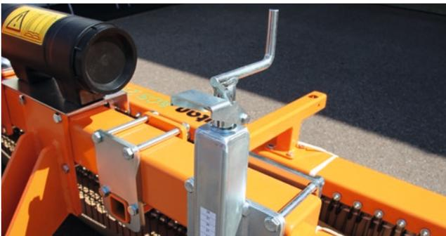
Skala und Tiefeneinstellung Spindel (rechts und links) am Polytan ACS 210
