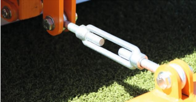
Einstellspindeln an Polytan ACS Geräten für Bürstenaufgedruck
